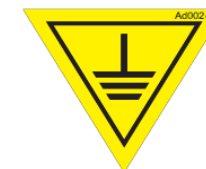
Figure 67 : mise à la terre.
