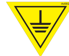
Figure 83 : mise à la terre.
