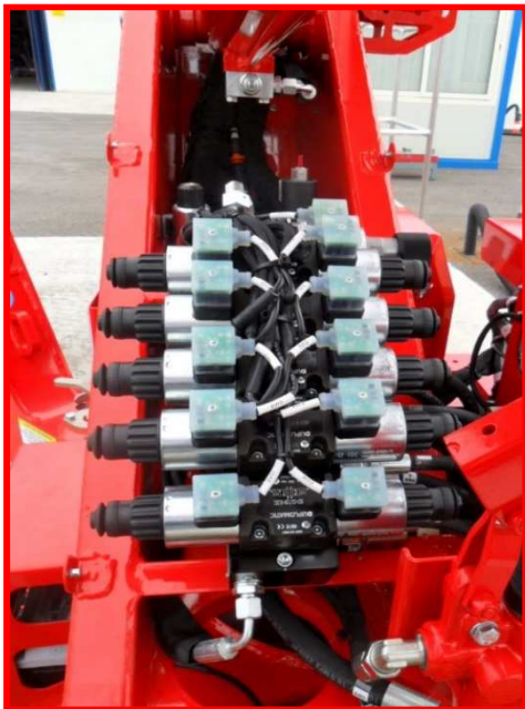
Figure 15 : banc vanne poste d'urgence.
