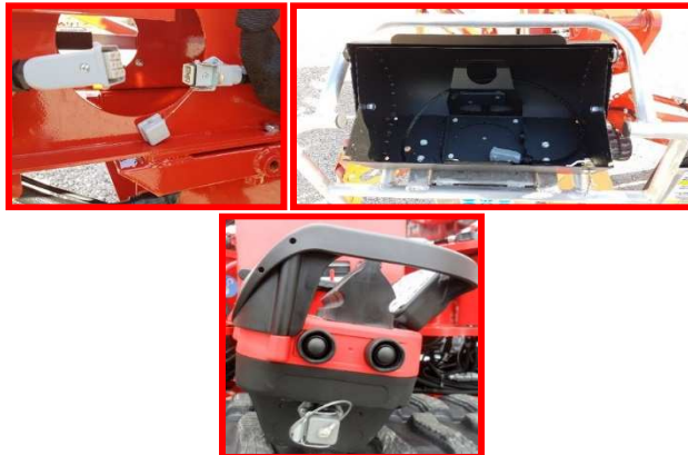
Figure 11 : connecteur du châssis et de la nacelle pour la télécommande filaire.
