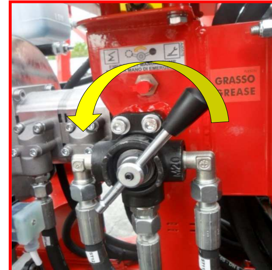
Figure 21 : robinet de la pompe manuelle en position de récupération de la plateforme.
