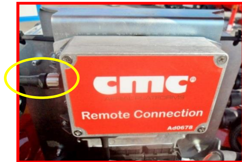
Figure 86 : Boîtier de connexion à distance.
