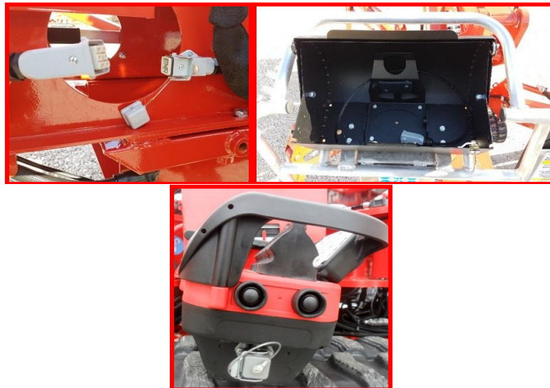
Figure 11 : connecteur du châssis et de la nacelle pour la télécommande filaire.
