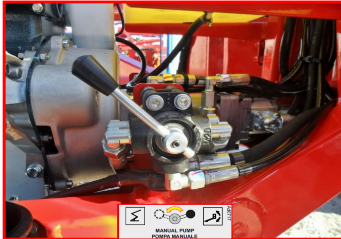
Figure 61 : robinet de la pompe manuelle.
