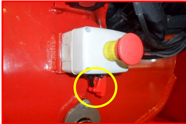
Figure 45 : bouton de by-pass de blocage de translation.
