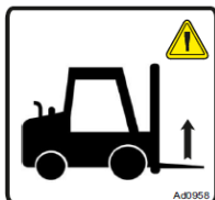
Figure 97 : indication des points d'enfourchement.
