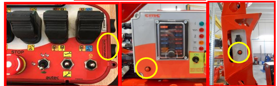
Figure 62 : activation de l'électropompe (*en option).
