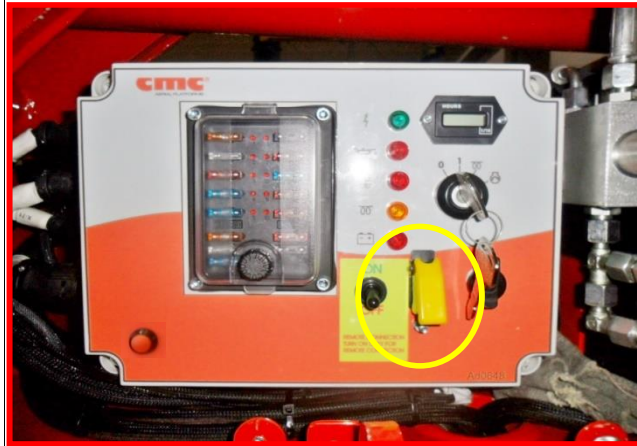
Figure 52 : bouton de by-pass d'urgence.
