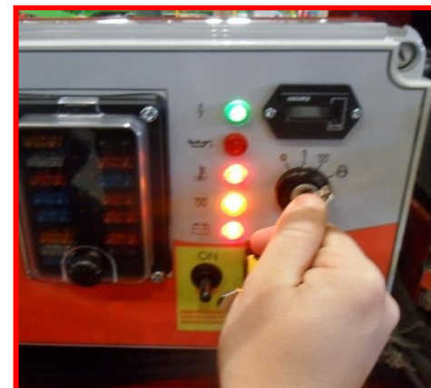
Figure 5 : phase de chauffage des bougies du moteur.
