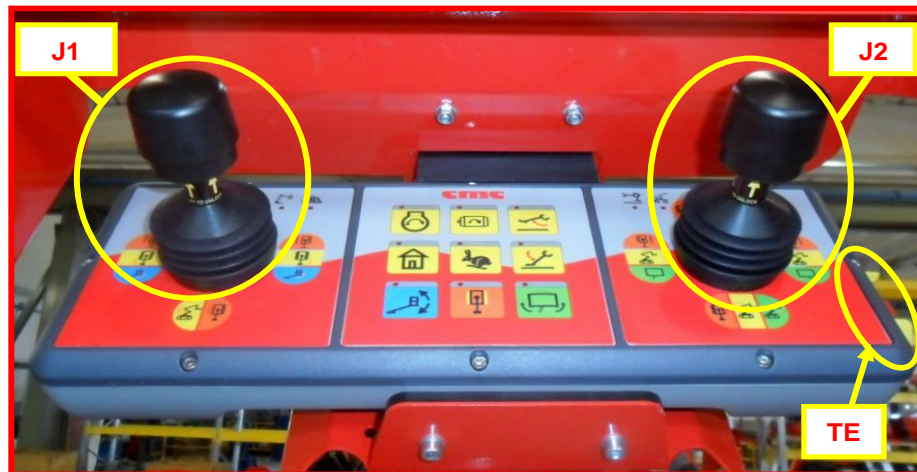
Figure 9 : poste de commande plateforme dans nacelle.
