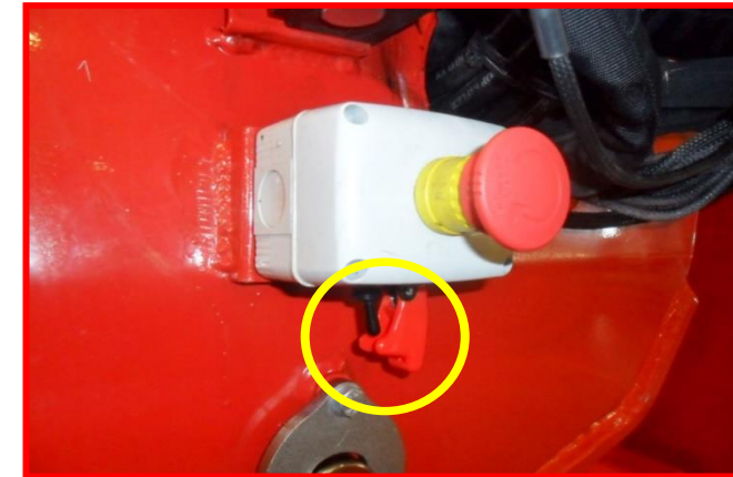
Afbeelding 45: toets voor bypass verplaatsingsblokkering.
