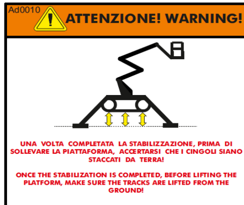
Afbeelding 92: waarschuwing stijging rupsbanden.
