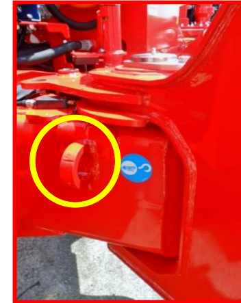
Figure 20 : crochets sur le châssis.
