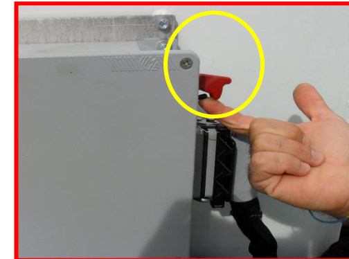
Figure 30 : bouton de by-pass d'urgence.
