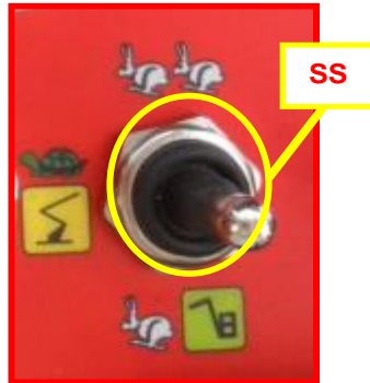
Figure 22 : sélecteur de vitesse sur radiocommande.
