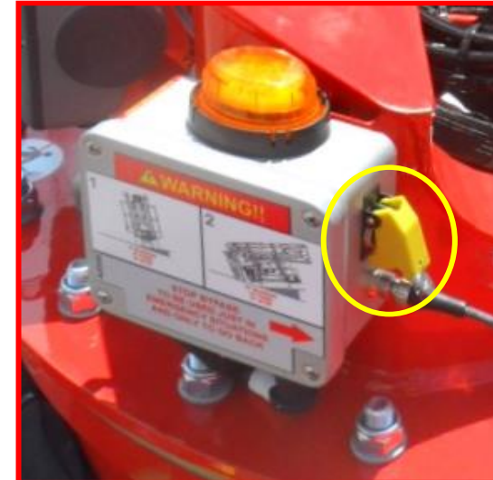
Figure 24 : bouton de by-pass de blocage de translation.
