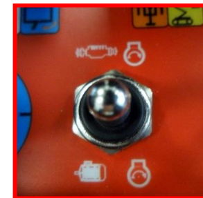
Afbeelding 5: hendel start/stop verbrandingsmotor/elektrische motor op de afstandsbediening.
