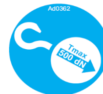
Afbeelding 73: aanduiding bevestigingspunten voor brugkraan.
