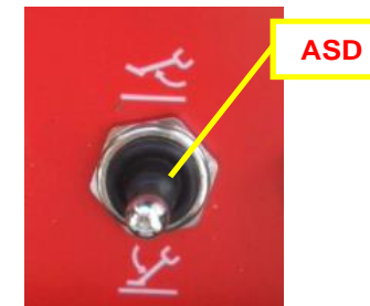
Afbeelding 26: keuzeschakelaar automatische stabilisatie/destabilisatie op de afstandsbediening.
