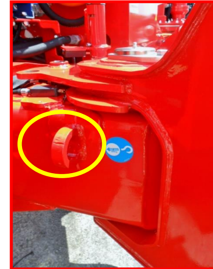
Afbeelding 20: bevestigingspunten op het onderstel.
