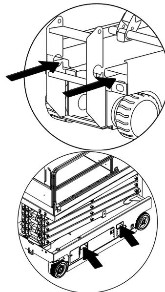
Placer les fourches des chariots élévateurs en position sur les entrées de fourche.
