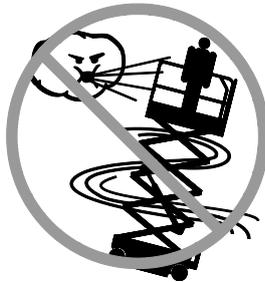
Ne pas utiliser la machine par vents forts ou en rafales. Ne pas augmenter la surface d'exposition de la charge ou de la nacelle. Plus la surface exposée au vent est grande, moins la machine est stable.
