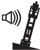
Replacer la machine sur une surface horizontale pour rétablir les fonctions d'élévation.
