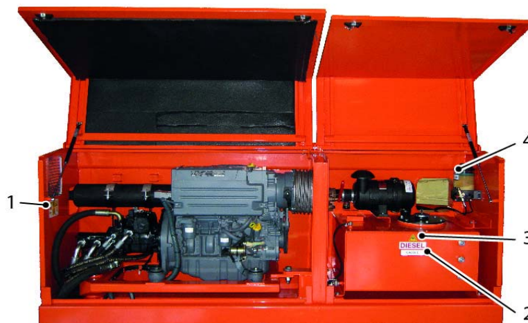
Dieselmotor- en centraal vetsmeersysteemcompartimenten
