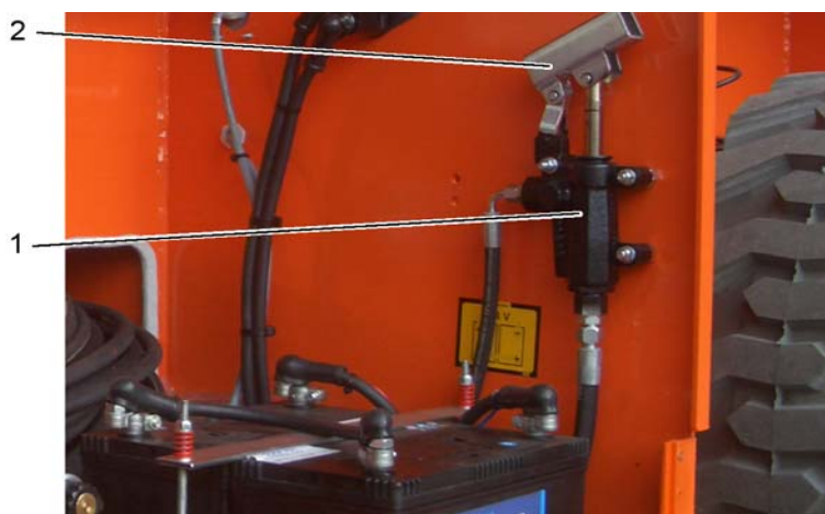
Handpomp voor het uitschuifdeel van het platform
