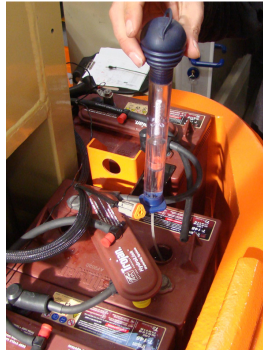
Figure 5-8. Mesure de la Densité de l'Electrolyte
