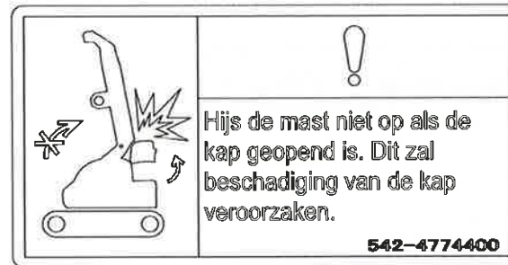
(48) Waarschuwing mast bediening (542-4774400) (2 plaatsen)
