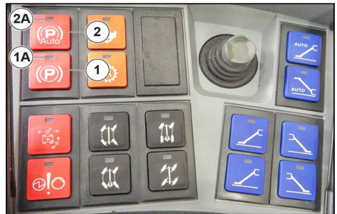
Figure 130: Utilisation du frein de stationnement
