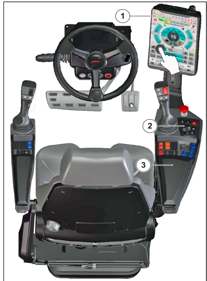
Figure 76: Mode de commande de l'affichage
