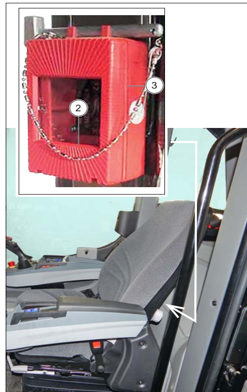
Figure 105: Coffret de sécurité
