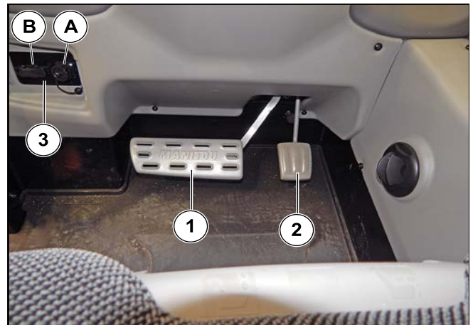
Figure 52: Pédales et prises de diagnostic
