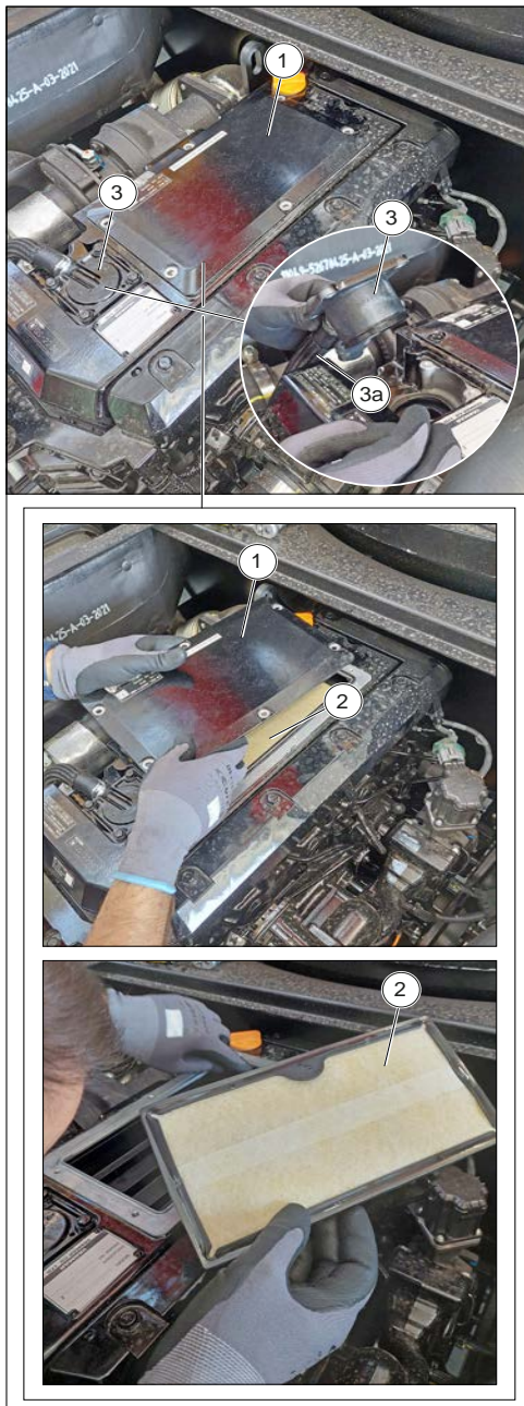
Figure 209: Remplacement du filtre du carter du reniflard du moteur
