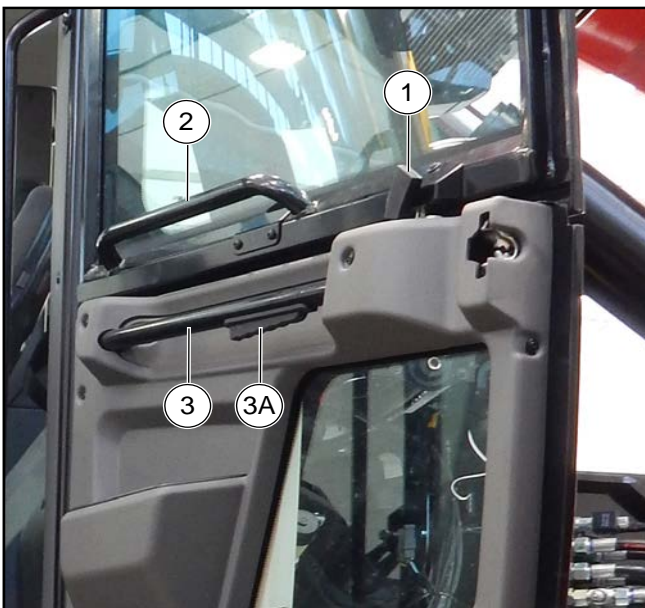
Figure 59: Ouvrir la porte et la vitre de la porte
