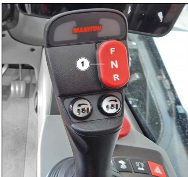
Figure 132: Utilisation du sélecteur FNR
