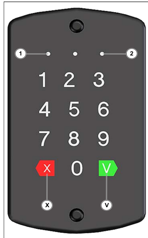
Afbeelding 74: 'Easy MANAGER' startblokkeringssysteem
