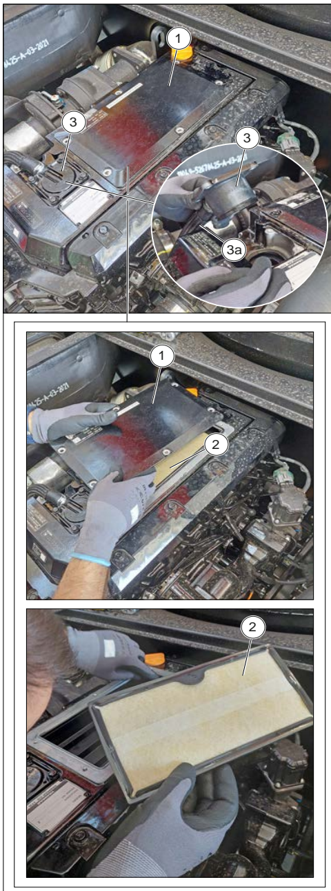
Afbeelding 209: Het carterfilter van de motorontluchter vervangen
