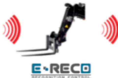
Figure 126: Reconnaissance d'un accessoire « E-RECO »
