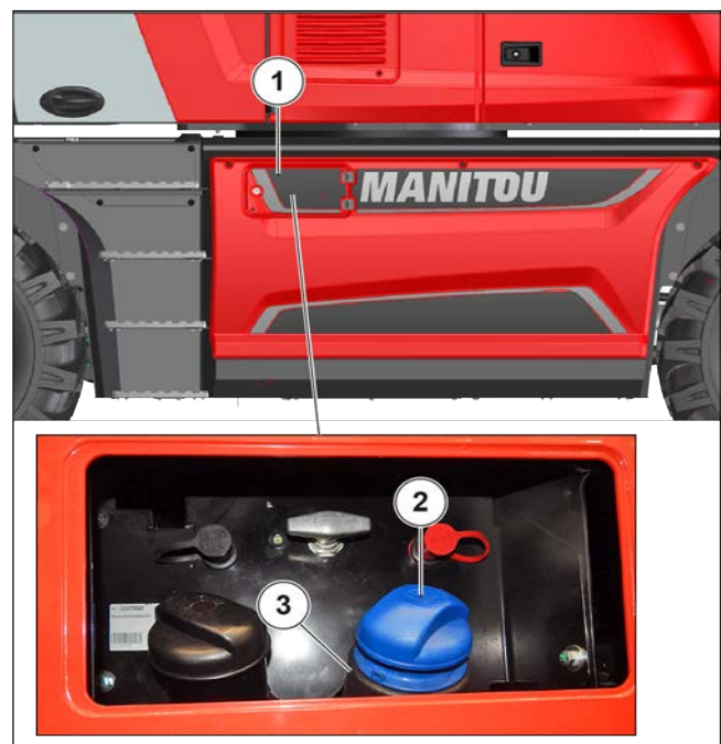
Figure 149: Vérification du niveau de liquide DEF
