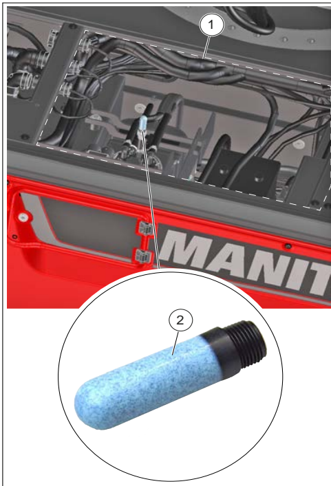
Afbeelding 205: De ontluchter van de DEF-tank vervangen
