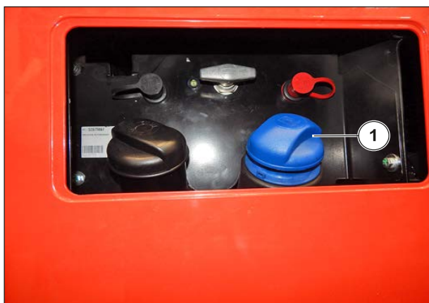
Afbeelding 122: Het reservoir voor DEF-vloeistof vullen
