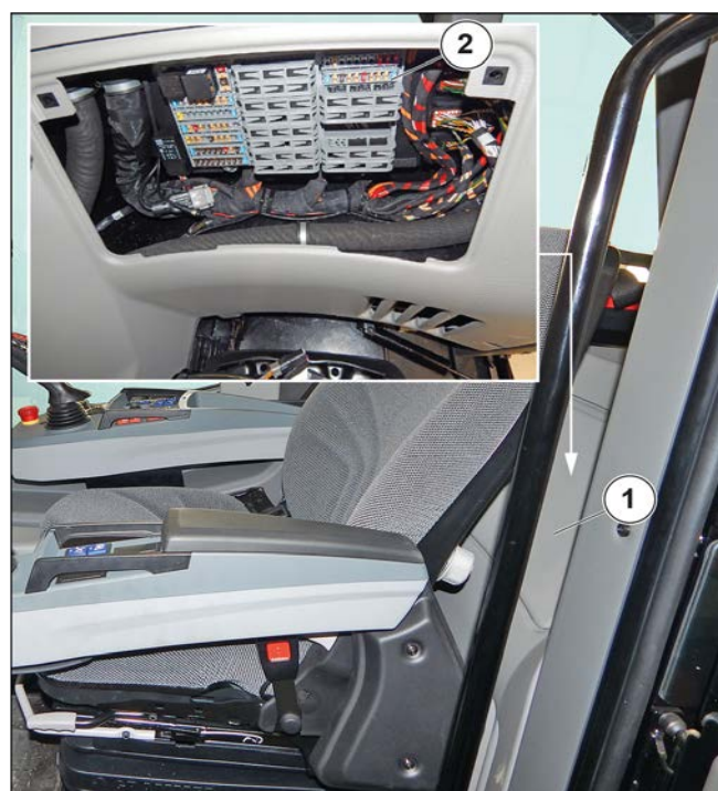
Afbeelding 214: Zekeringen en relais in cabine
