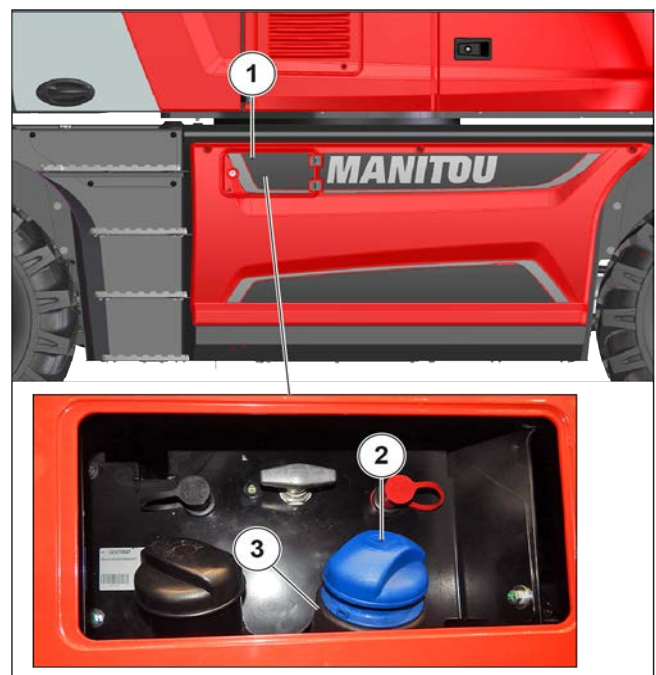
Figure 149: Vérification du niveau de liquide DEF
