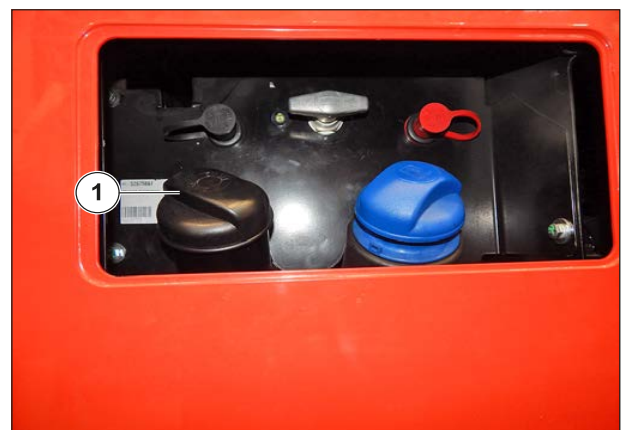
Afbeelding 121: De brandstoftank vullen
