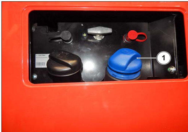
Afbeelding 122: Het reservoir voor DEF-vloeistof vullen
