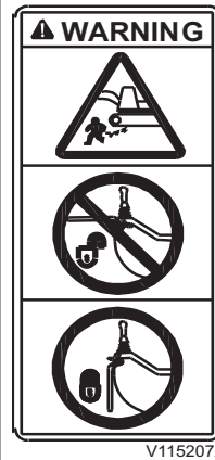
34 WAARSCHUWING! Alvorens de machine te verlaten de veiligheidsblokkeringshendel omlaagduwen om de bediening te blokkeren.
