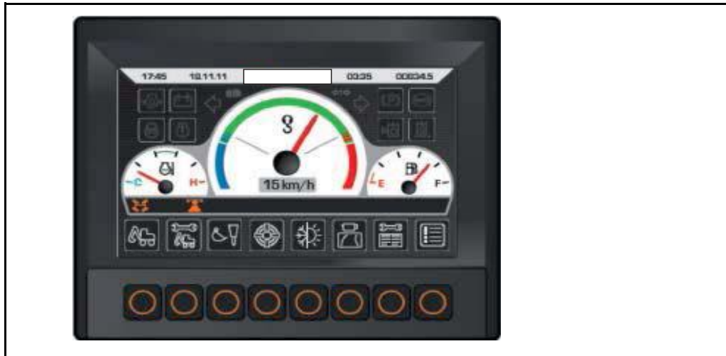
Fig. 5-42 écran avec avertisseur de surcharge activé
