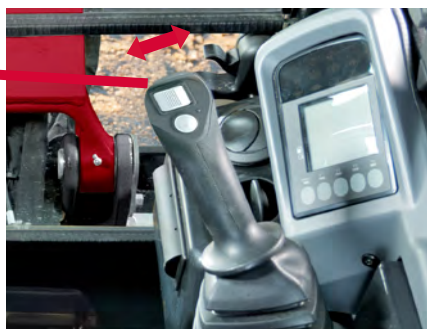
2 Bouton de réglage PTO proportionnel
